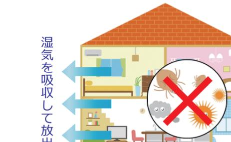
微細な連続気泡セルが湿気を吸収して放出。内部結露の発生を抑え、カビやダニの繁殖、木材の腐食から住まいを守ります。壁が水分を含んで垂れ下がる心配もありません。
