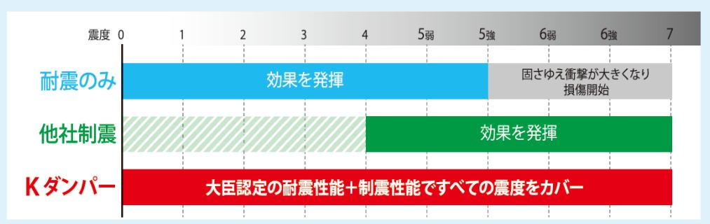
\*Kダンパーは、震度3~4程度までは耐震壁として機能し、それ以降は制震ダンパーとして効果を発揮します。また、層間変形角1/250~1/200程度から、最大級のエネルギー吸収効果を発揮します。
